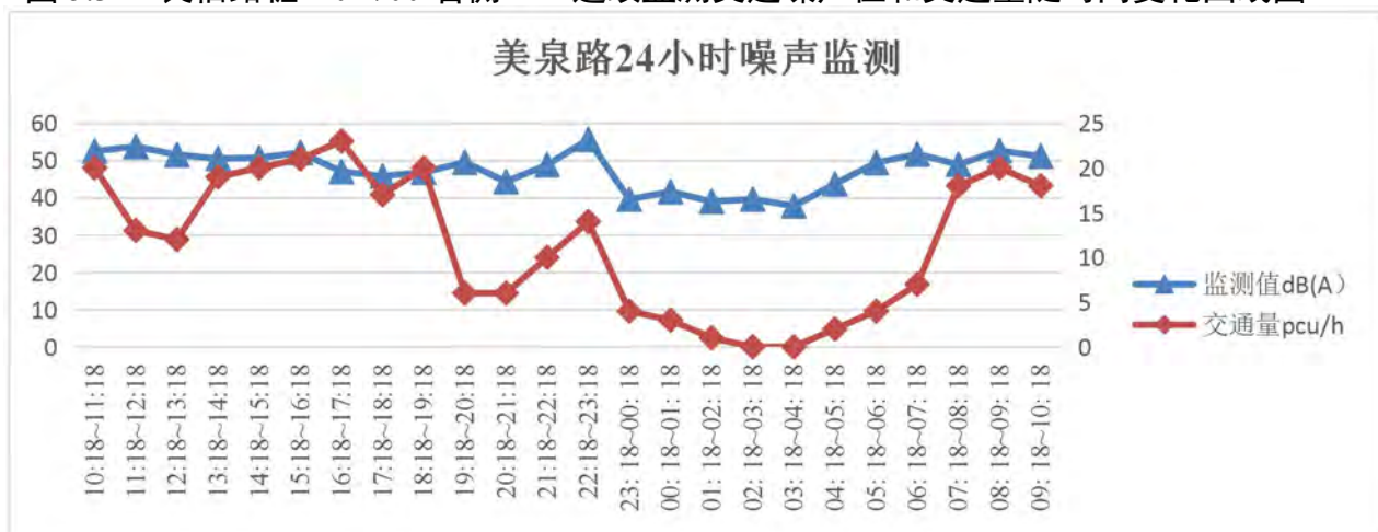
图 5.3-2 美泉路桩 K0+850 右侧 24h 连续监测交通噪声值和交通量随时间变化曲线图
