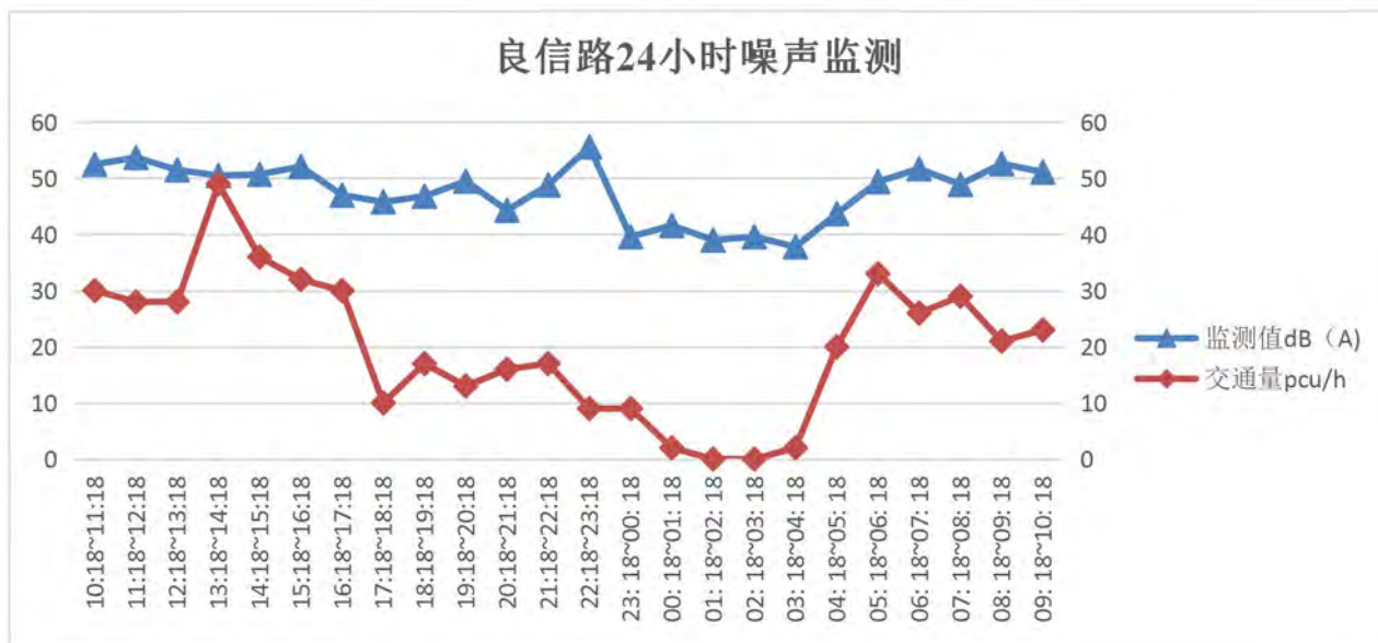
图 5.3-1 良信路桩 K0+700 右侧 24h 连续监测交通噪声值和交通量随时间变化曲线图
